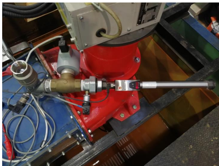
Obr. 5.19 Pohled na elektromagnetický ventil s clonou a průtokoměrem vzduchu TESTO
