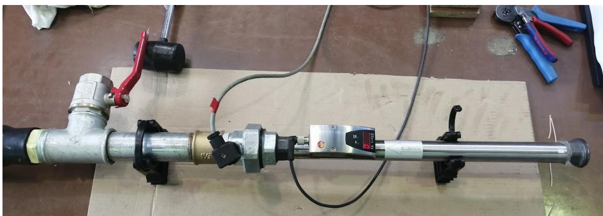
Obr. 5.11 Pohled na kalibraci clon pomocí průmyslového vysavače a průtokoměru vzduchu
