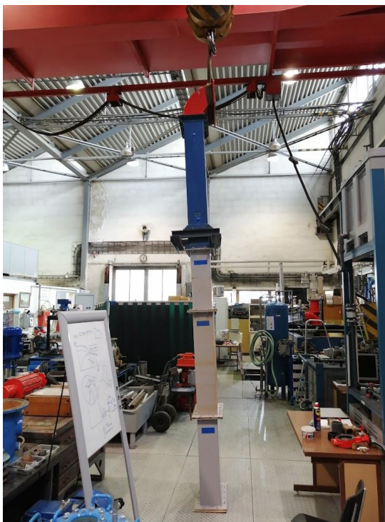
Obr. 5.23 Pohled na segmentovou část násosky, která ústí do DN o maximální délce 240 cm
