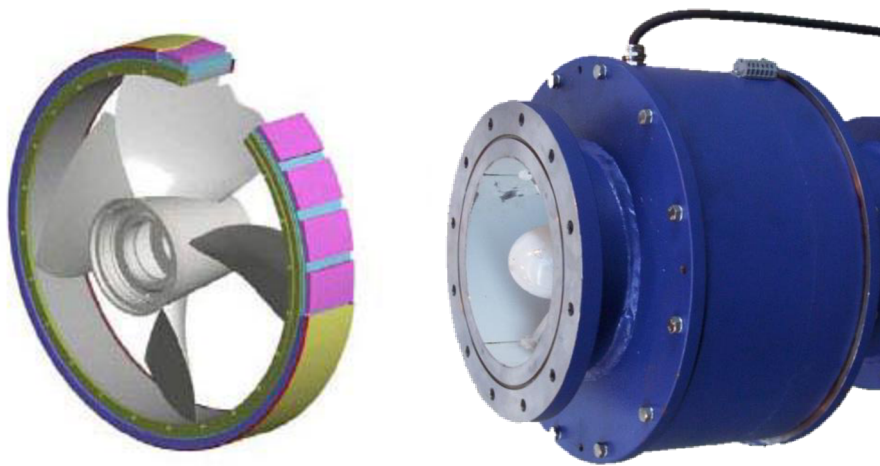
Obr. 3.6 Model Vírové turbíny s prstencovým motorem [17]
