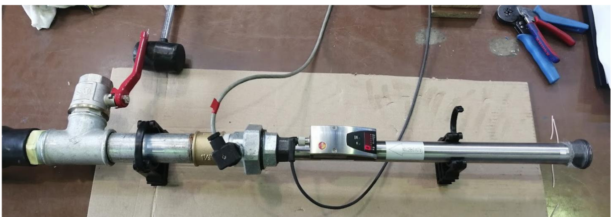
Obr. 5.11 Pohled na kalibraci clon pomocí průmyslového vysavače a průtokoměru vzduchu
