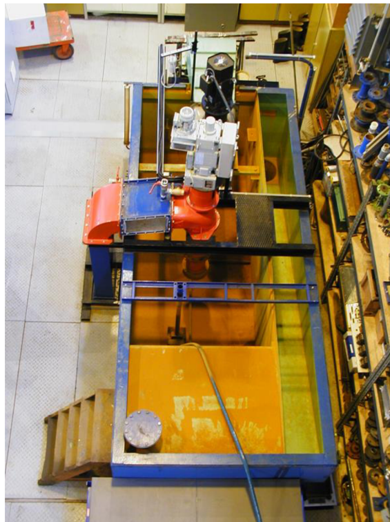
Obr. 5.2 Celkový pohled na stanici mikroturbín s instalovanou násoskovou turbínou
