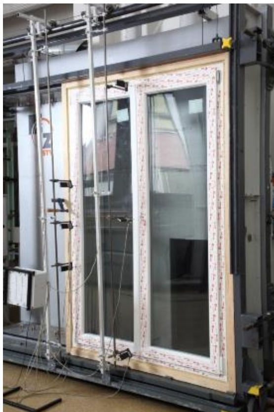
Obr. 6: Vzorek okna při zkoušení odolnosti proti zatížení větrem Chyba! Nenalezen zdroj odkazů.
