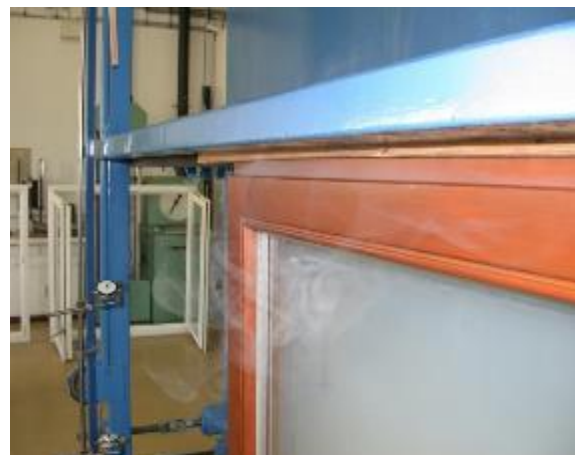
Obr. 2: Okno při zkoušení průvzdušnosti s použitím detekčního plynu Chyba! Nenašel jsem zdroj odkazů.
