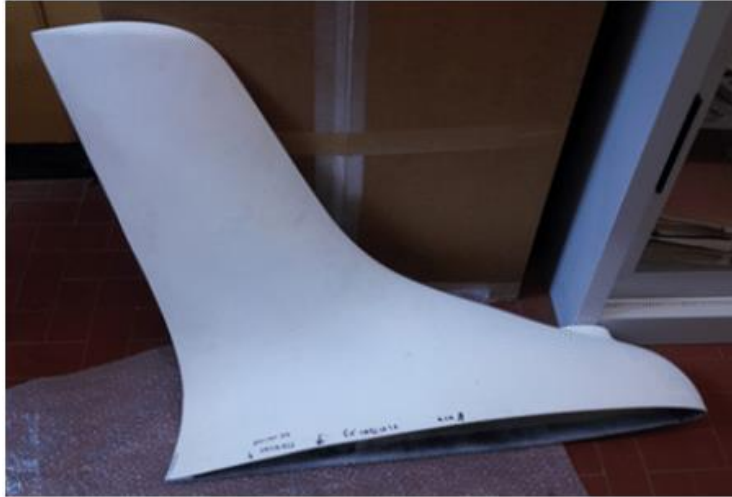
Obr. 4-1 skořepinová konstrukce wingletu malého letounu [5]
