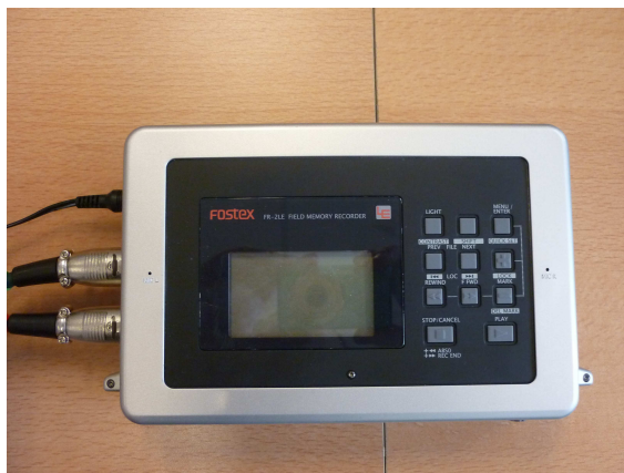
Obr. 3.4: Přenosný 2.stopý rekordér FOSTER FR-2L.
