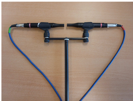
Obr. 3.3: Akustická intenzitní sonda sestavená ze dvou mikrofonů MiniSPL bez distanční vložky.
