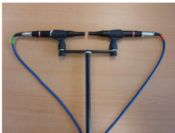
Obr. 3.3: Akustická intenzitní sonda sestavená ze dvou mikrofonů MiniSPL bez distanční vložky.
