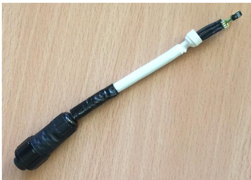
Obr. 12 Senzorová sonda se senzorem SHT75
