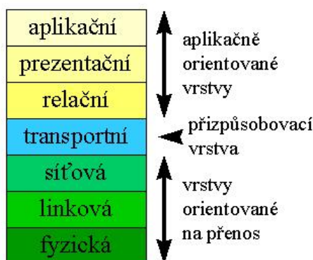
Obr. 6 Referenční model OSI (zdroj: http://www.umel.feec.vutbr.cz/~adamek/komp/data/iso.htm )
