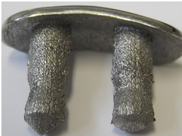
Obr. 2-13 3D tištěný titanový lokální implantát do kolene [34]
