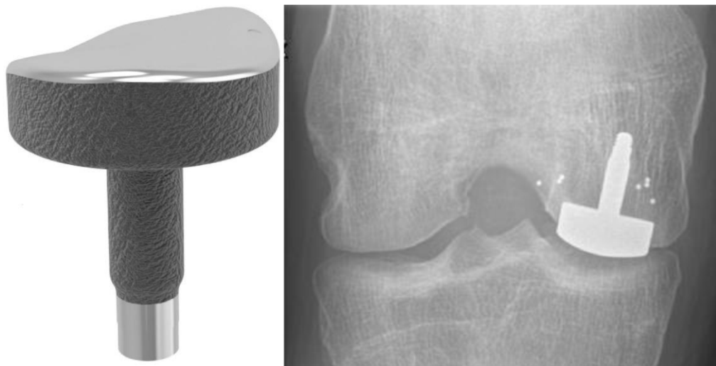
Obr. 2-12 Lokální kloubní implantát Episurf Medical, vpravo rentgenový snímek aplikovaného implantátu [30]
