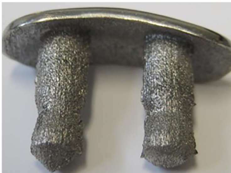
Obr. 2-13 3D tištěný titanový lokální implantát do kolene [34]
