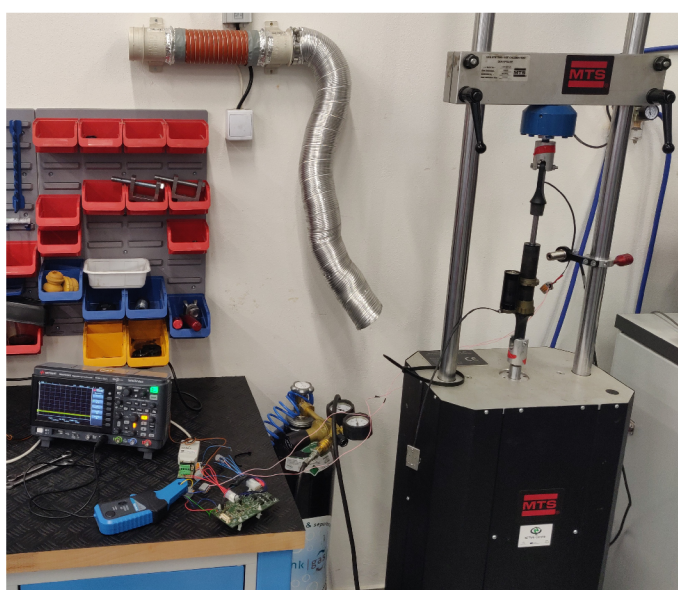
Obrázek 3.18: Měření F-v charakteristiky
