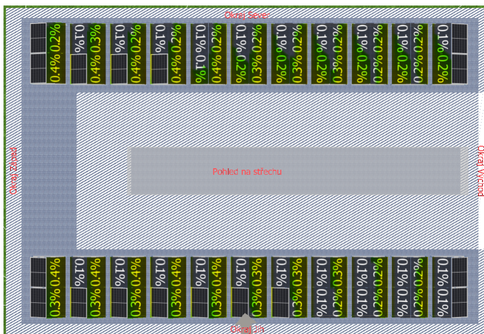
Obr. 3.4: Simulácia tienenia FV modulov počas roka
