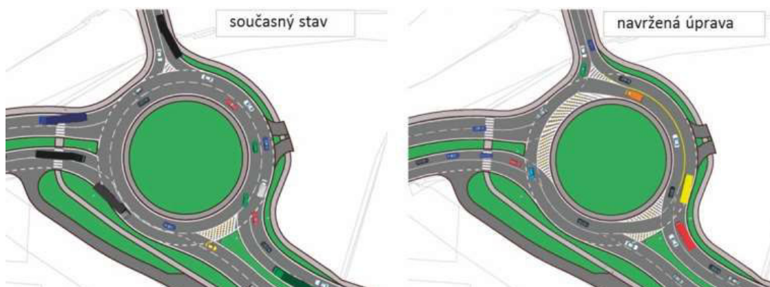
Obr. 25: Příklad koncepčního návrhu turbo-okružní křižovatky; vlevo současný stav a vpravo navrhovaná úprava.
