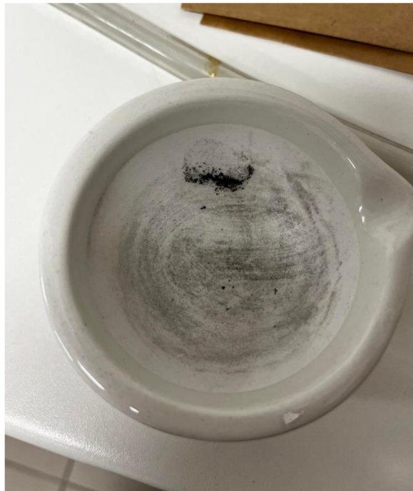
Obrázek 8 - Spálený vzorek PAN bez oxidace.
