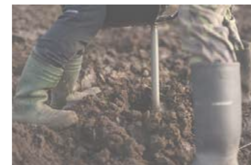
Obr. 31 - Odebírání vzorků půdy
