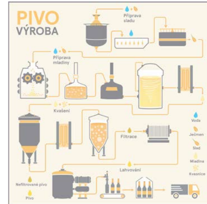
Obr. 53 - Schéma výroby piva
