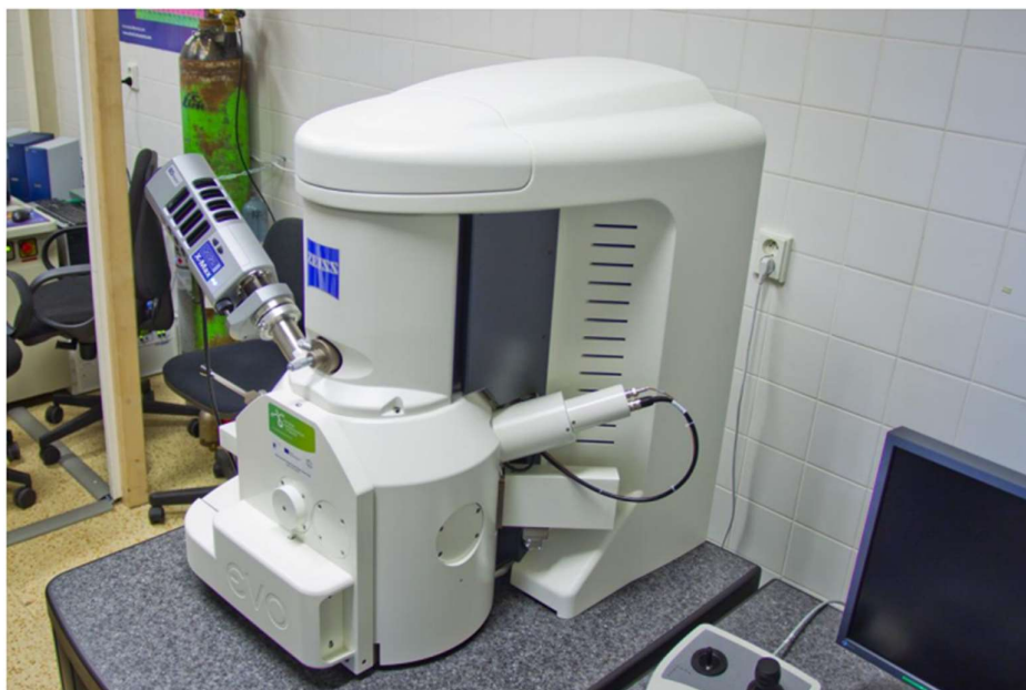
Obrázek 8: Měřicí komora s detektory rastrovacího elektronového mikroskopu ZEISS EVO LS 10
