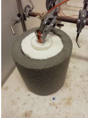
Obrázek 5: Tepelně-izolační komora 16 kanálového isoperibolického kalorimetru
