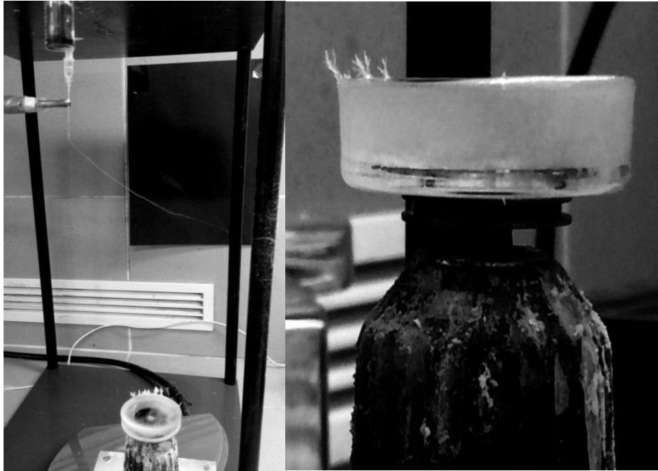
Obrázek 29: Přerušný proces elektrostatického zvlákňování do kolektoru s technickým lihem. Vysušený polymerní proud visící z kovové jehly, unášený do prostoru. Okolo kolektoru vznikající „krápníky“ z polymerního roztoku PCL.
