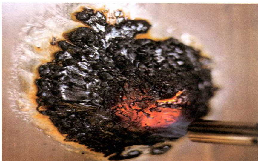
Obrázek 20 Detail vzniku nehořlavé krusty [28]
