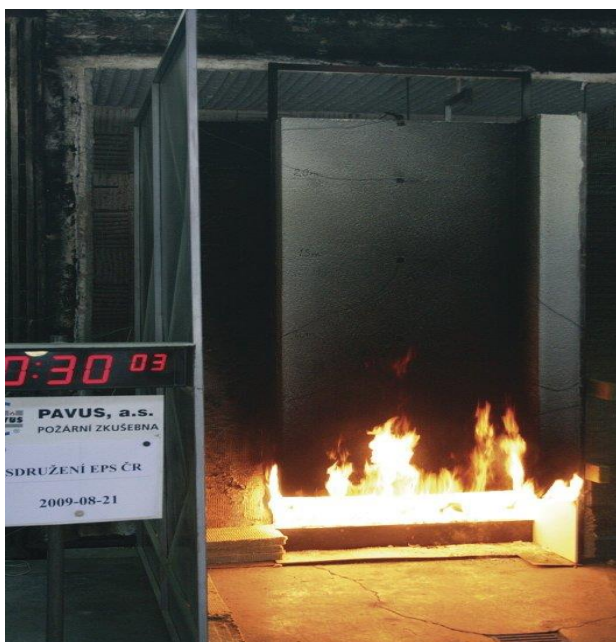
Obrázek 14 Zkouška pořádní bariéry [21]
