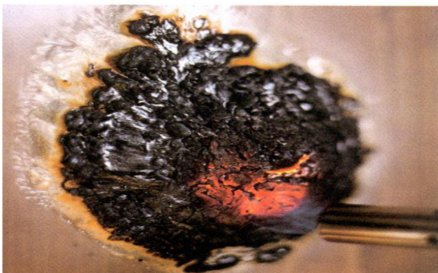
Obrázek 20 Detail vzniku nehořlavé krusty [28]
