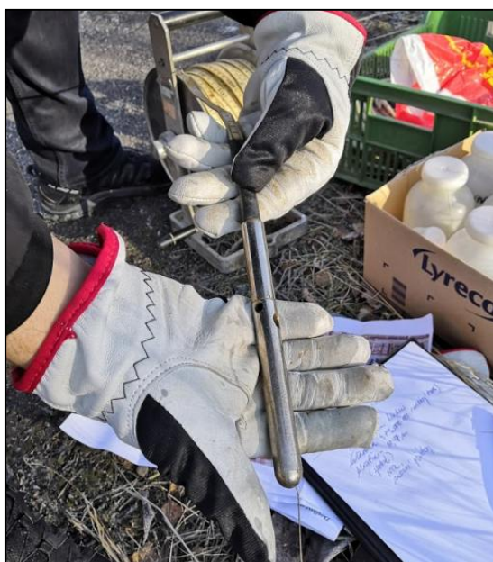
Obrázek 12: Detail čidla akustické signalizace hladinoměru
