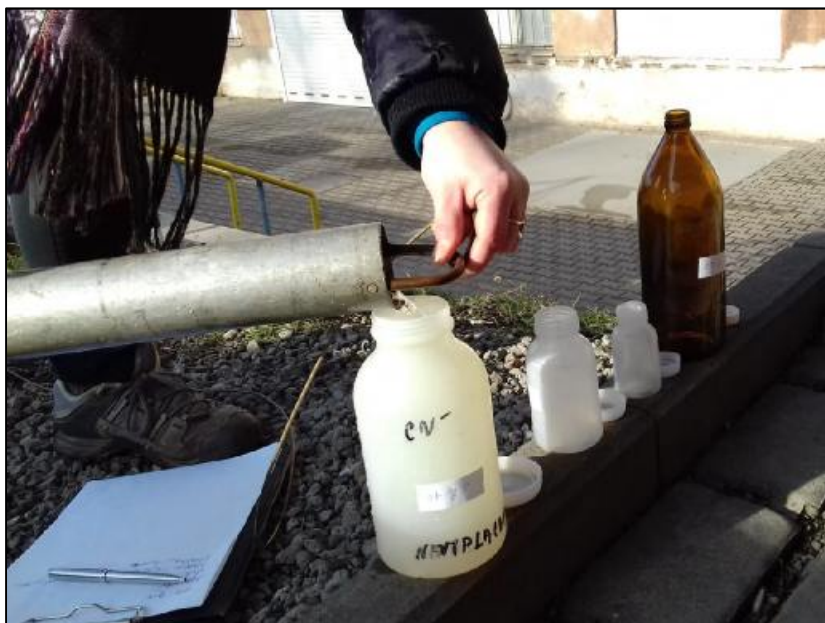
Obrázek 14: přelévání vzorku z objemového vzorkovače do vzorkovnice
