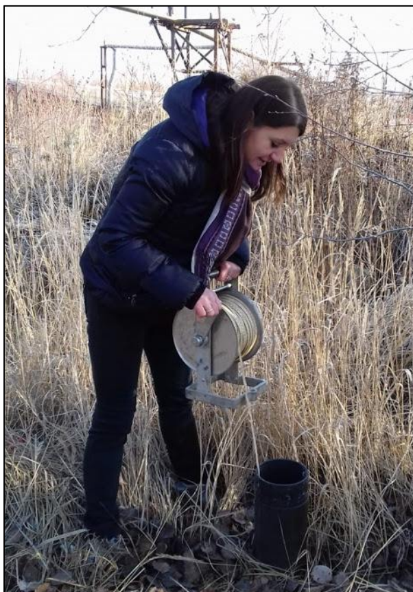
Obrázek 13: Záměr hladiny podzemní vody
