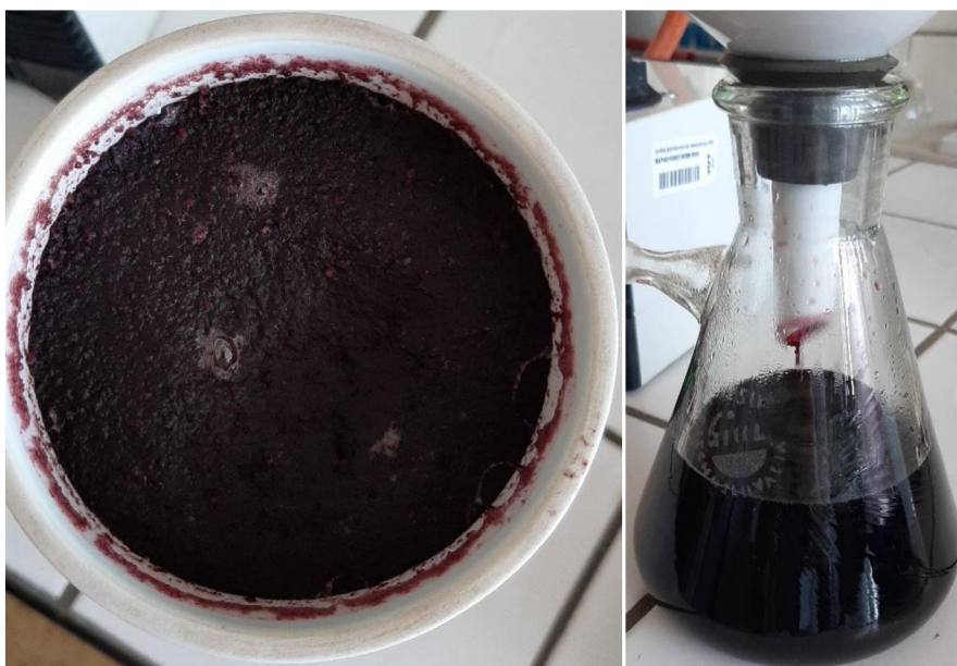
Obrázek 12 Drcená aronie po extrakci a filtraci (vlevo) a výsledný filtrát po extrakci
