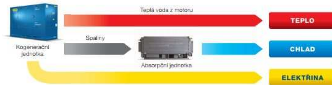
Obr.7.7. Trigenerace pro celoroční potřebu chladu i tepla [9]
