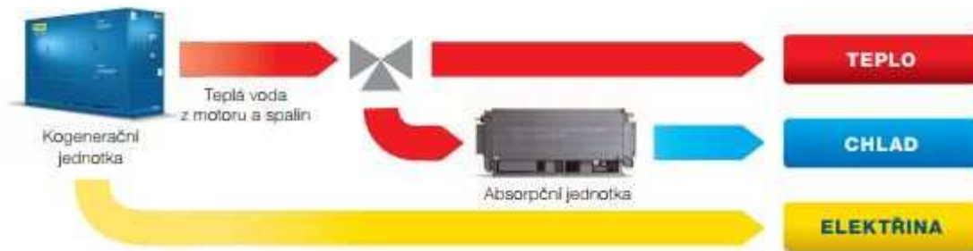
Obr.7.6. Trigenerace pro střídavou potřebu vytápění/chlazení[9]
