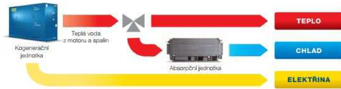
Obr.7.6. Trigenerace pro střídavou potřebu vytápění/chlazení[9]
