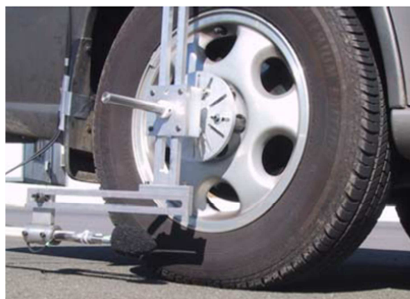
Obr. 19: Zavěšený mikrofon při metodě CPI [2]
