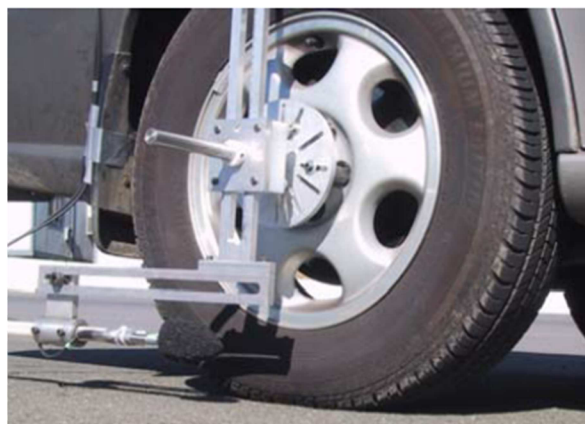
Obr. 19: Zavěšený mikrofon při metodě CPI [2]
