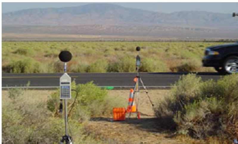
Obr. 17: Příklad vhodně zvoleného měřícího místa [2]
