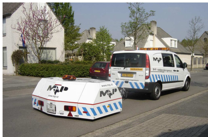
Obr. 18: Měřící zařízení na přívěsu za vozidlem [6]
