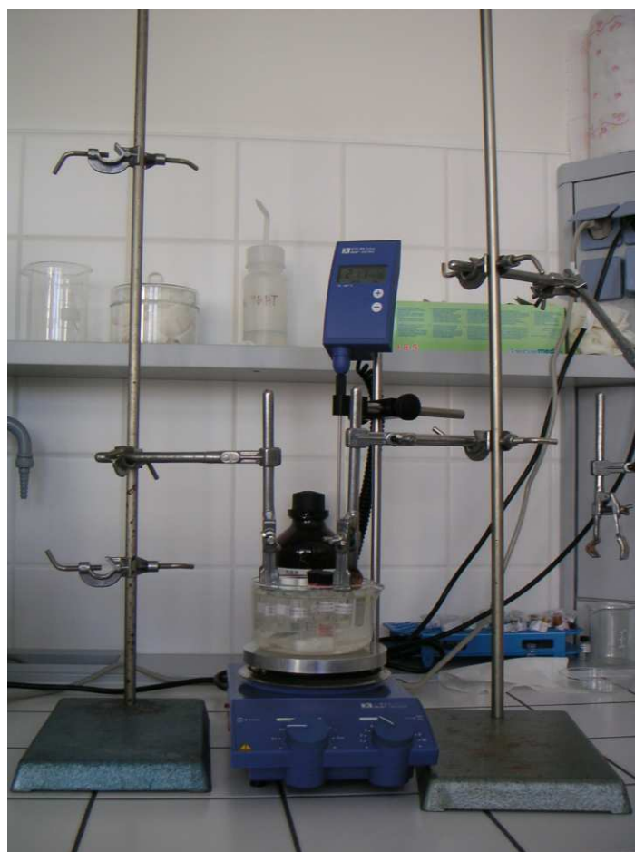
Obr. 26: Vodní lázeň pro měření sol-gel přechodů
