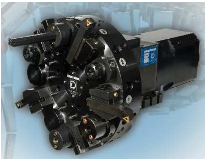
Obr. 2: Nástrojová hlava Duplomatic s bubnovým uspořádáním nástrojů [2]
