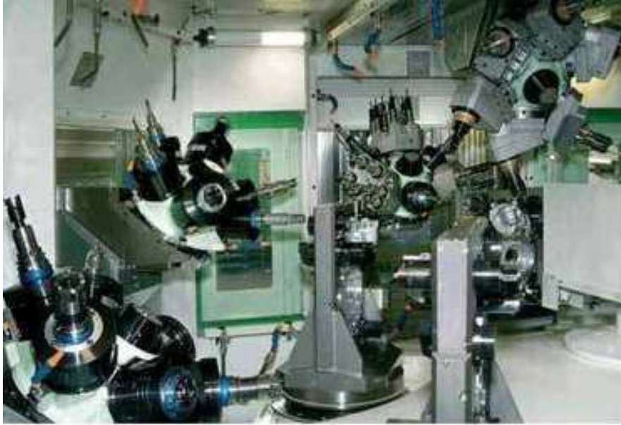
Obr. 4: Obráběcí centrum VERTIFLEX 450 s vícevřetenovou hlavou [4]
