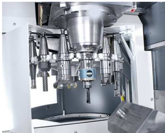
Obr. 5: PICK-UP výměna nástrojů – DMU 50 eco [6]
