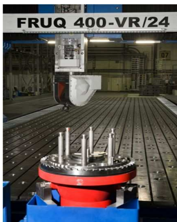
Obr. 11: Obráběcí centrum s posuvným portálem od firmy TOS Kuřim [10]
