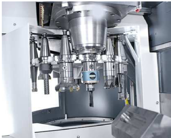
Obr. 5: PICK-UP výměna nástrojů – DMU 50 eco [6]
