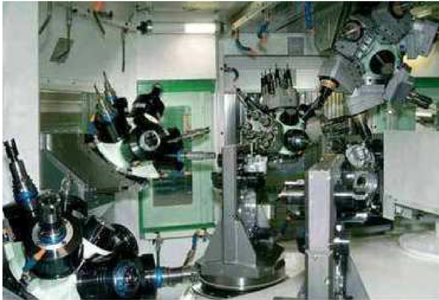
Obr. 4: Obráběcí centrum VERTIFLEX 450 s vícevřetenovou hlavou [4]
