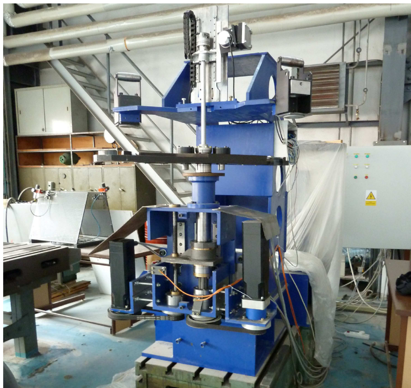
Obr. 18: Zkušební stand STD – 25 pro systémy automatické výměny nástrojů
