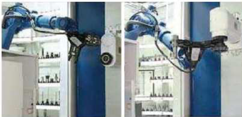
Obr. 10: Systém AVN Tool Arena firmy Demmeler při výměně nástroje v horizontální a vertikální poloze [1]
