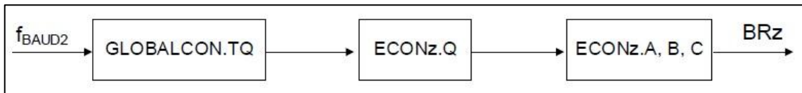
Obrázek 3.6: Předdělička (nastavení přenosové rychlosti) [2].
