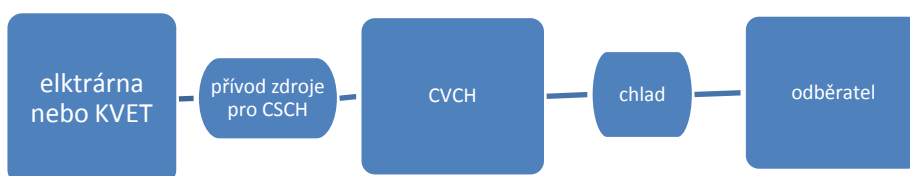
Obr. 15 Soustava s centralizovanou výrobou chladu
