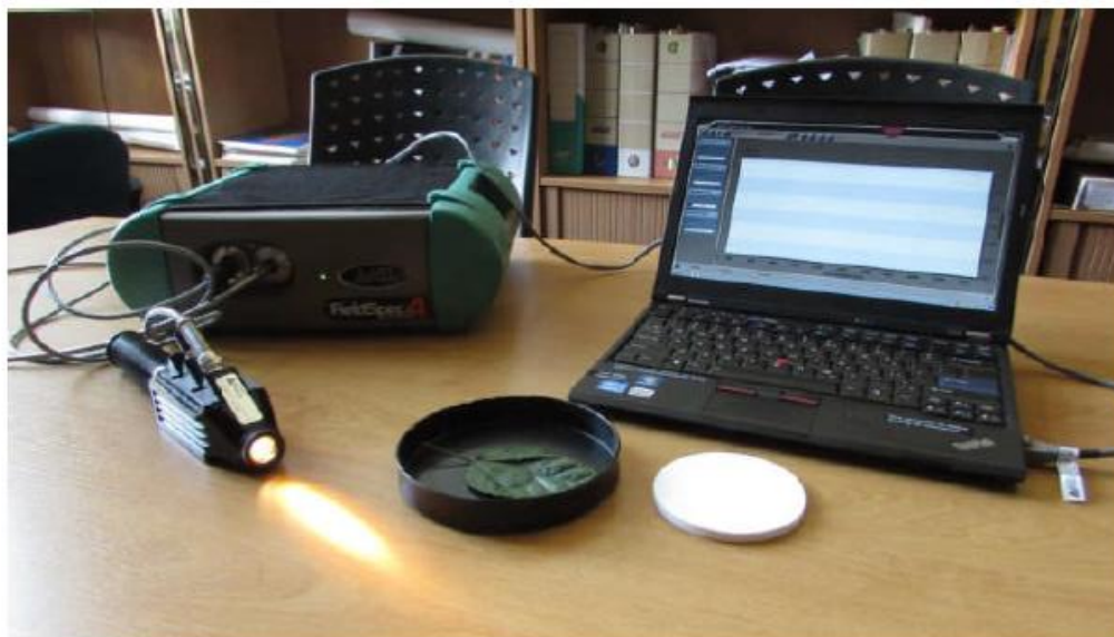
Obrázek 8: Spektrometr ASD FieldSpec 4 WR s kontaktní sondou ASD Plant Probe připravený k měření (Albrechtová a kol., 2017)
