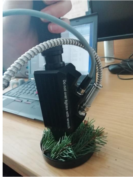
Obrázek 10: Měření kontaktní sondou ASD Plant Probe
