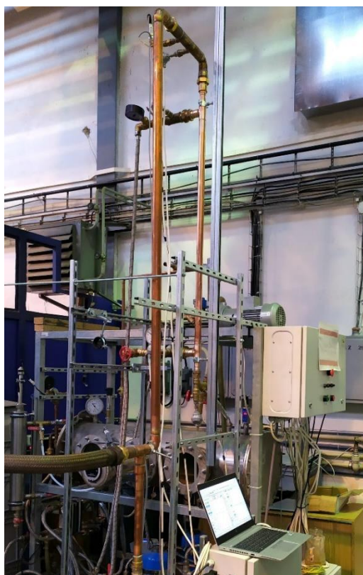
Obr.4.1 Experimentální zařízení s výměníkem „trubka v trubce“
