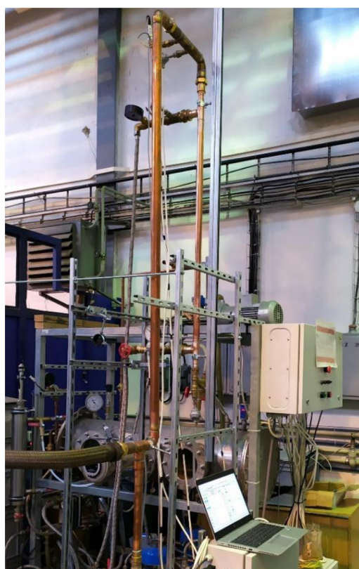
Obr.4.1 Experimentální zařízení s výměníkem „trubka v trubce“
