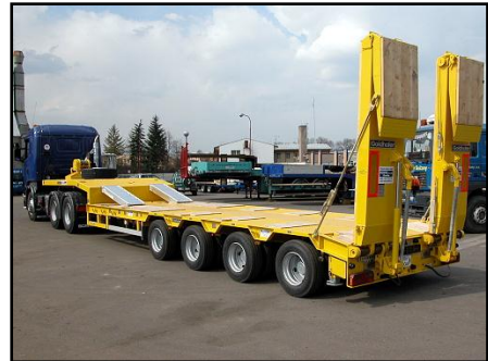
Obr.27 Tažná souprava Goldhofer STN-L 4
