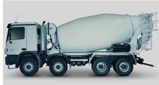
Obr.32 Autodomíchávač Schwing Stetter AM 8 C Light Line
