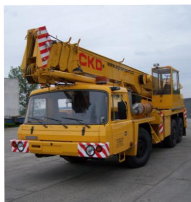
Obr.30 Autojeřáb Tatra AD28
