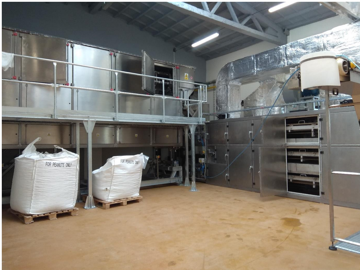
Obrázek 6 – Mikrovlnná linka s dohřevnou zónou společnosti IBK Trade (foto autorka)
