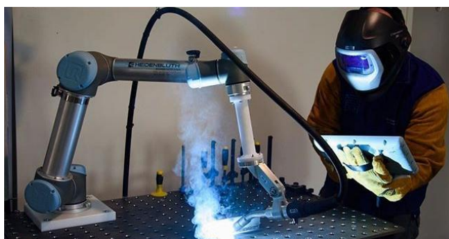
Obr. 1.17 - Svařování kolaborativním robotem [45]
