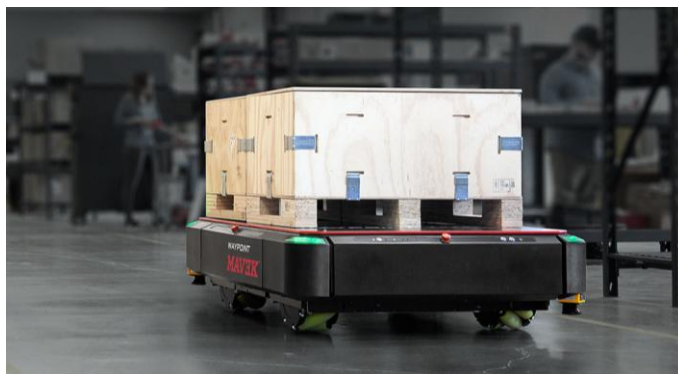
Obr. 1.6 - Autonomní mobilní podvozek Waypoint MAV3K [21]
