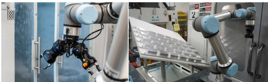
Obr. 1.20 - Obsluha CNC stroje [42], Zakládání polotovaru do stroje [49]
