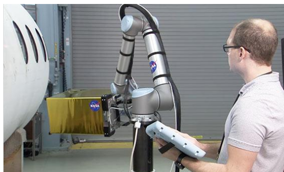
Obr. 1.18 - Kontrola trupu letadla NASA [46]
