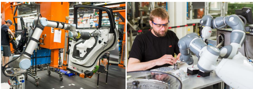
Obr. 1.21 - Montáž dveří BMW [50], Montáž elektrické zásuvky [52]
