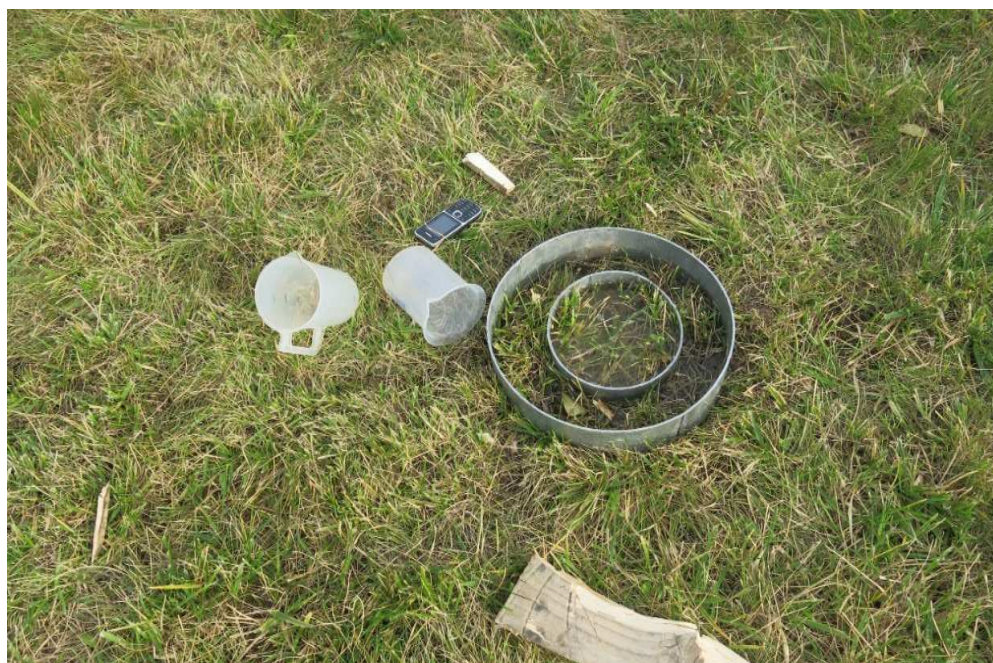
Obr. 2: Měření infiltrace půdy (foto autor)
