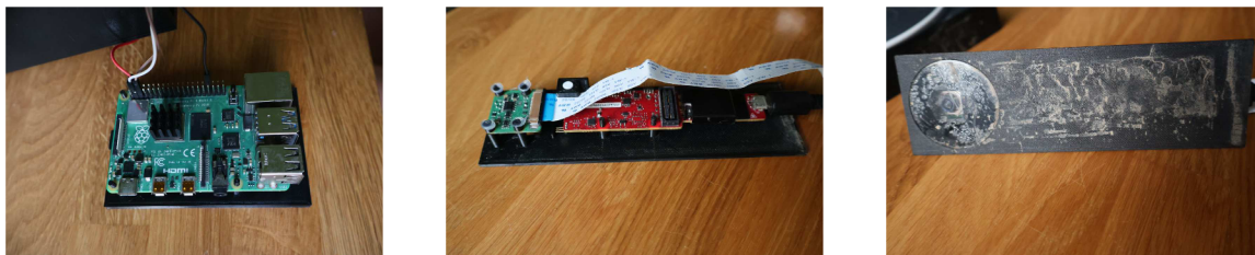
Obrázek 5.3: Části pro sestavení zařízení. Zleva část pro uchycení Raspberry Pi, Uchycení radaru a kamery ze zadní a přední strany.
