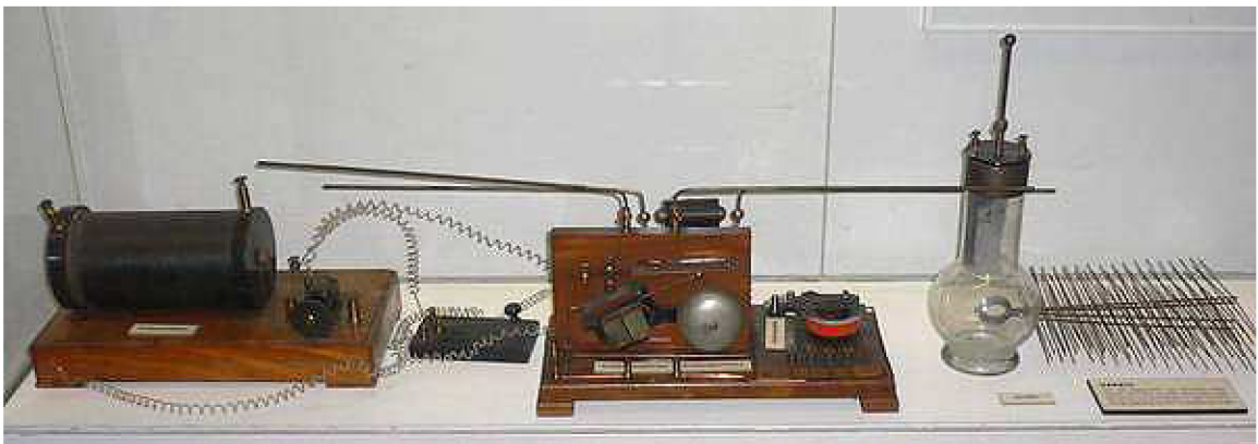
Obrázek 3.1: Zařízení Telemobiloscope vytvořené německým inženýrem Christianem Hülsmejerem. Převzato z [41].
