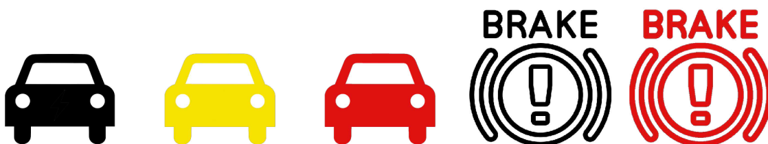
Obrázek 5.8: Ikony použité pro vizualizace radarových dat. Zleva tři ikony pro zobrazení vozidel za cyklistou dle jejich rychlosti. Zbývající dvě ikony pro zobrazení stavu prudkého zpomalení.
