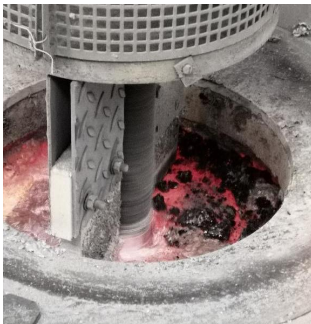
Obr. 6 Přístroj OZAL 001 na odplynění taveniny
