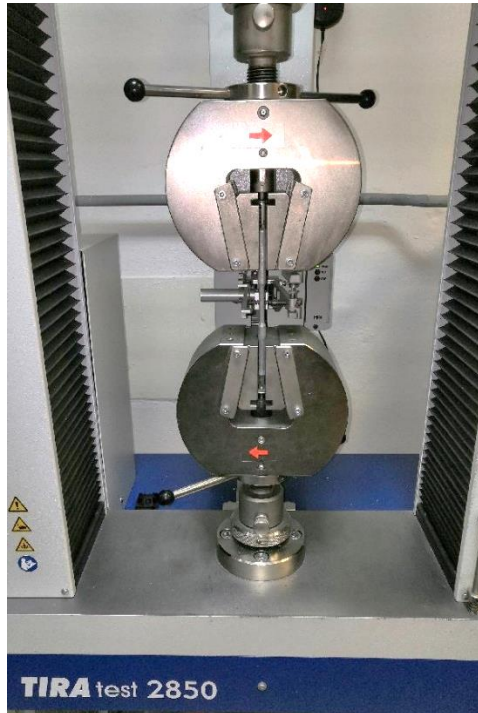
Obr. 28 Zařízení pro statickou zkoušku tahem TIRA test 2850
