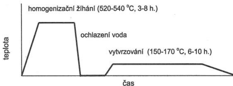
Obr. 11 Diagram tepelného zpracování při vytvrzování za tepla (orientační hodnoty)
