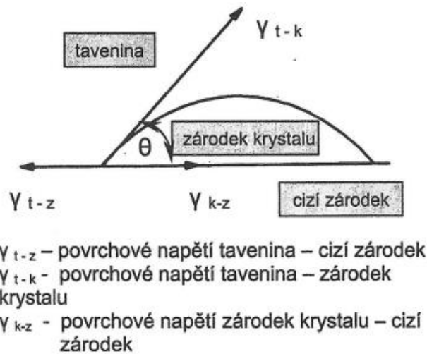
Obr. 18 Smáčivost tuhnoucí fáze a krystalizačního zárodku
