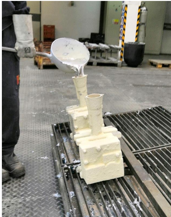
Obr. 8 Odlévání formy na licím poli
