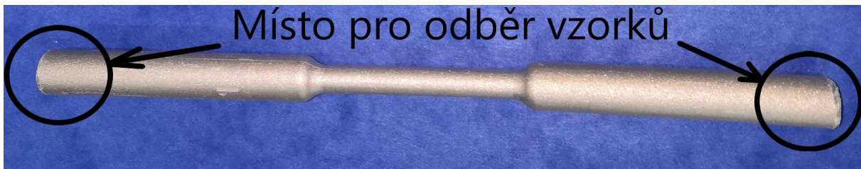
Obr. 27 Místa pro odběr vzorků pro vyhodnocení mikrostruktury
