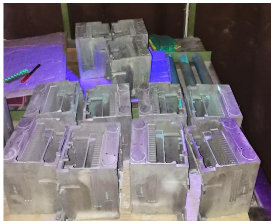
Obr. 13 Odlitky na penetrační zkoušce pod UV světlem
