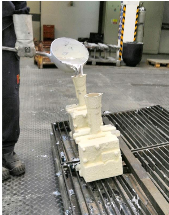
Obr. 8 Odlévání formy na licím poli
