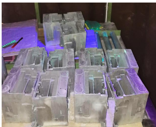
Obr. 13 Odlitky na penetrační zkoušce pod UV světlem
