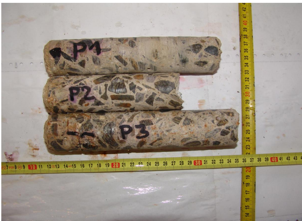
Obrázek 13: Jádrové vývrty betonu trámu, průměr 45 mm
