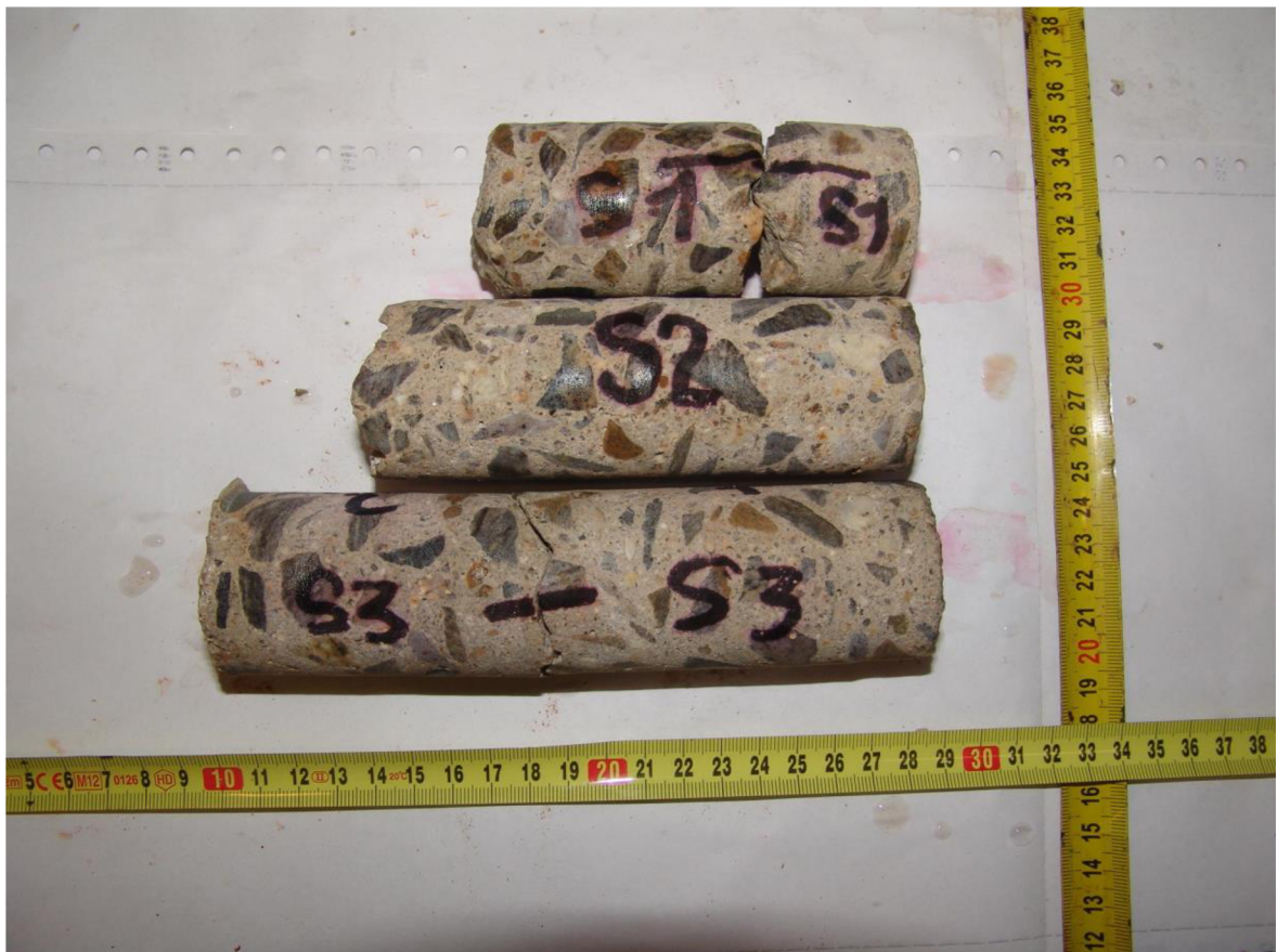
Obrázek 12: Jádrové vývrty betonu stropní desky, průměr 45mm
