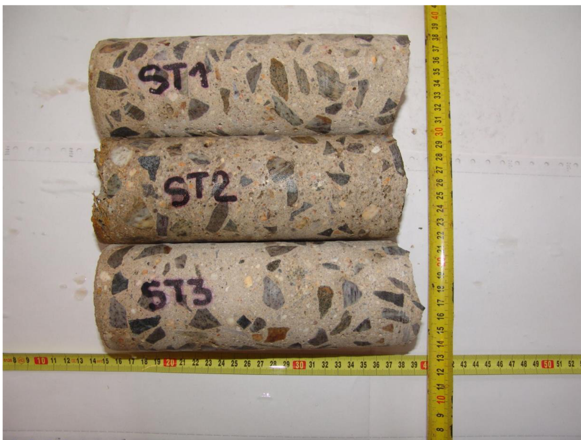
Obrázek 14: Jádrové vývrty betonu sloupů, průměr 75 mm
