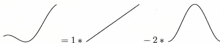
Obr. 39 Deformace a její aproximace součtem tvarů tělesa [24]
