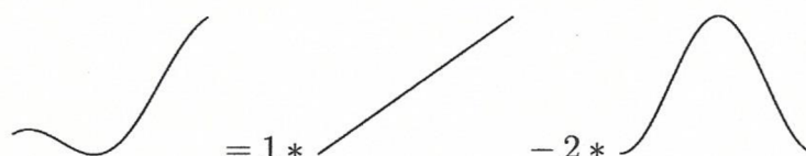
Obr. 39 Deformace a její aproximace součtem tvarů tělesa [24]
