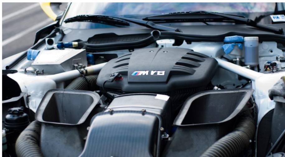
Obr. 10 Motor BMW P65B44 ve voze BMW Z4 GT3
