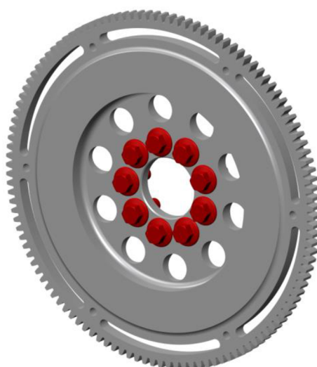
Obr. 29 Sestava setrvačnicku a jeho náhrada v MBS
