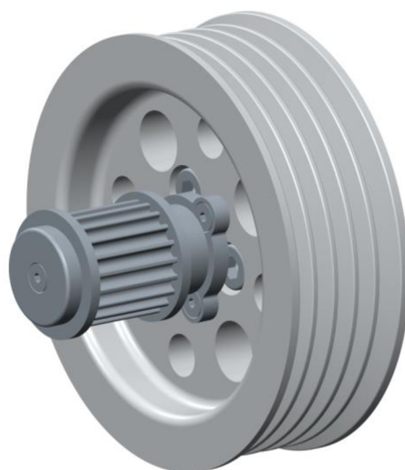
Obr. 28 Sestava řemenice a její náhrada v MBS
