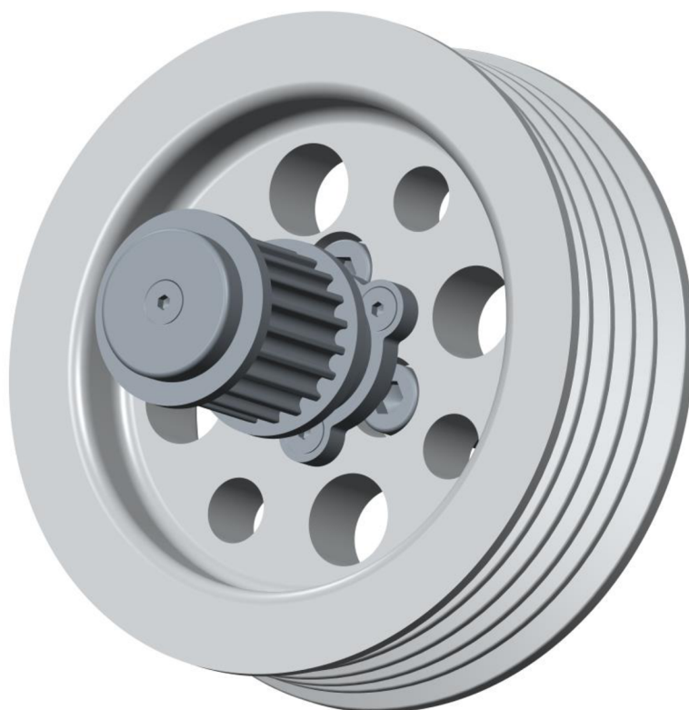
Obr. 81 Sestava řemenice a pohonu olejových čerpadel
