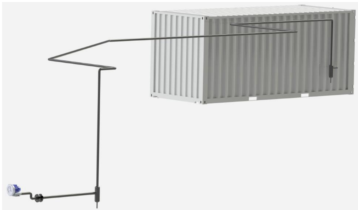
Obrázek 5.3: Potrubní trasa pro návrh vhodného dmyhadla - pohled 2.
