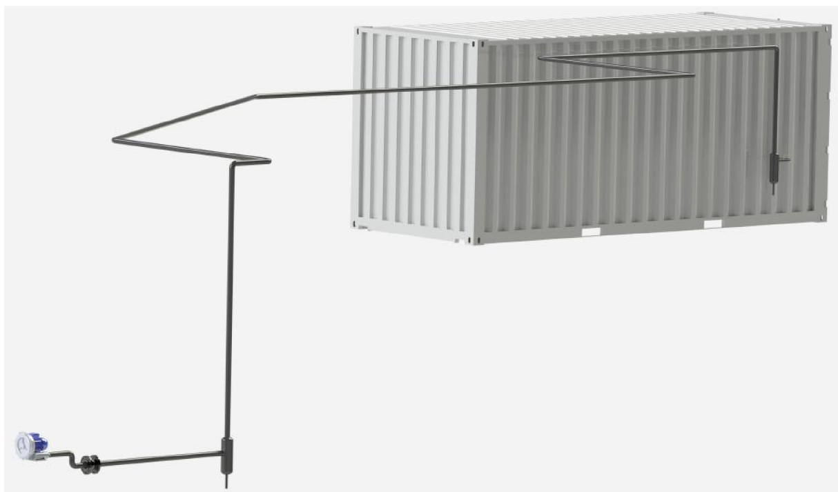
Obrázek 5.3: Potrubní trasa pro návrh vhodného dmyhadla - pohled 2.
