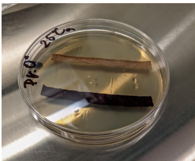
Obrázek 29 Preparát testu AATCC 147
