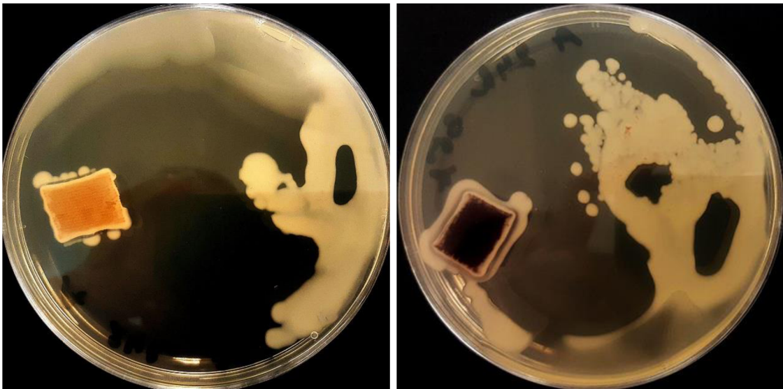
Obrázek 52 Výsledek nánosu (b) po 2 dnech, kvasinky Ampelos, vlevo bavlna, vpravo konopí
