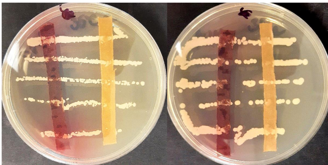
Obrázek 31 Výsledky testu AATCC 35°C, vlevo Dr. Oetker, vpravo Ampelos
