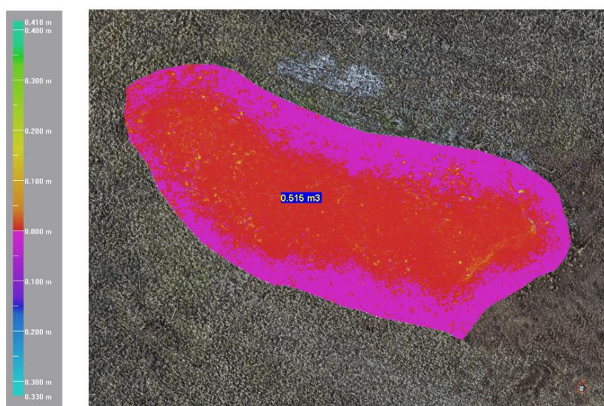
Obr. 47 - Lysolaje: vyjádření výškových rozdílů barevnou hypsometrií – Agisoft x Drone2Map
