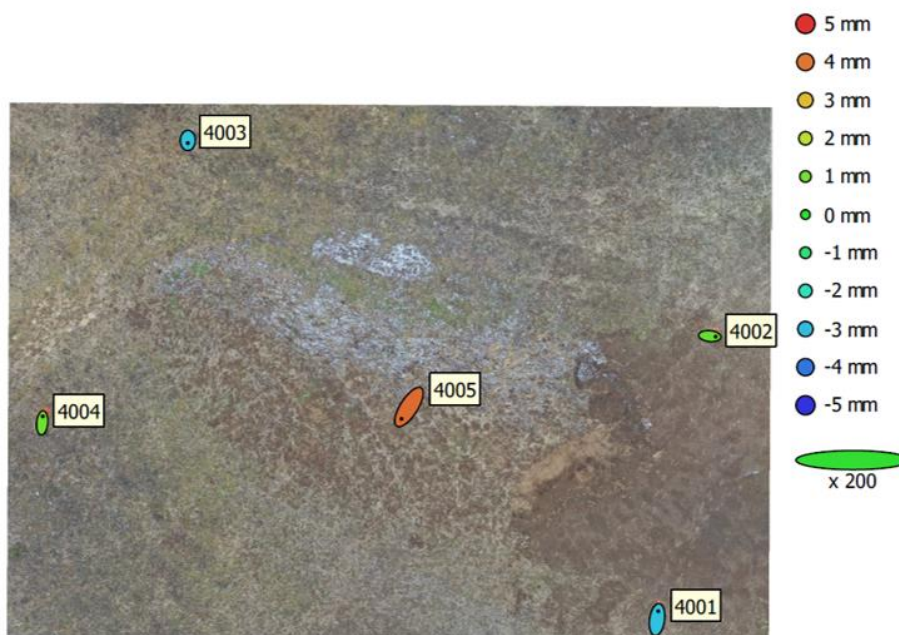
Obr. 41 - Umístění GCP a odchyly georeference v Lysolajích
