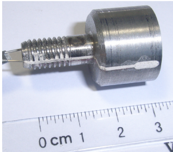
Obrázek 3.3: Etapa I - vrtaný senzor se dvěma termočlánu (A.2)
